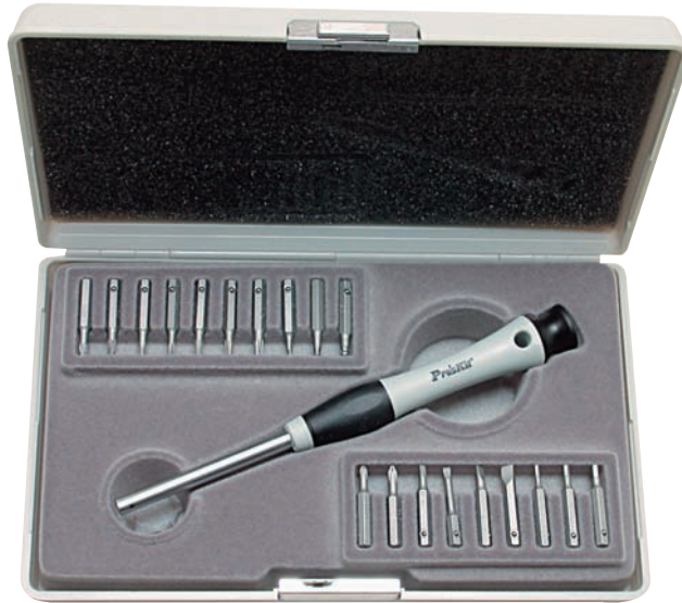
Figura 9. Una buena opción puede ser un set de puntas para destornillador. Este kit incluye puntas planas Phillips, Torx y Allen.
