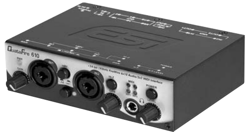
Figura 9. QuataFire es una tarjeta de sonido externa con conexión Firewire muy popular.
