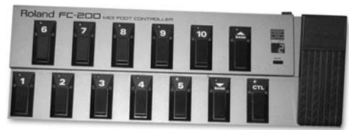
Figura 21. La Roland FC-200 es una controladora MIDI de pedales, muy popular, ideal para disparar sonidos de un sampler.
