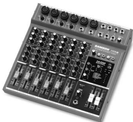
Figura 30. Samson MDR-8 es una consola de ocho canales, especialmente diseñada para su uso en estudios de producción basados en computadoras.
