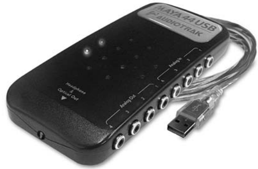
Figura 8. La Maya 44USB es una placa de audio con cuatro entradas y cuatro salidas independientes sumamente económica y con conexión USB.
