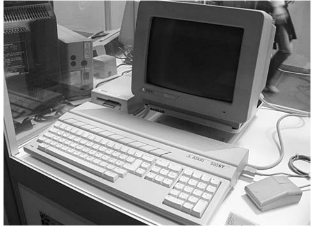
Figura 2. La Atari 520ST fue la primera en incorporar puertos MIDI y la culpable de la revolución tecnológica en la producción musical por computadora.
