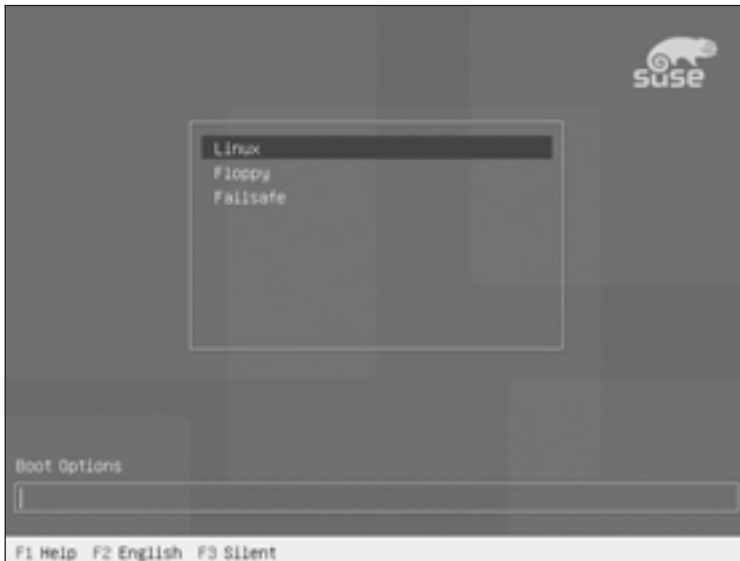
Figura 10. Si nuestra distribución nos muestra un menú gráfico de inicio, debemos presionar la tecla ESC para pasar al modo de línea de comandos de LILO.
