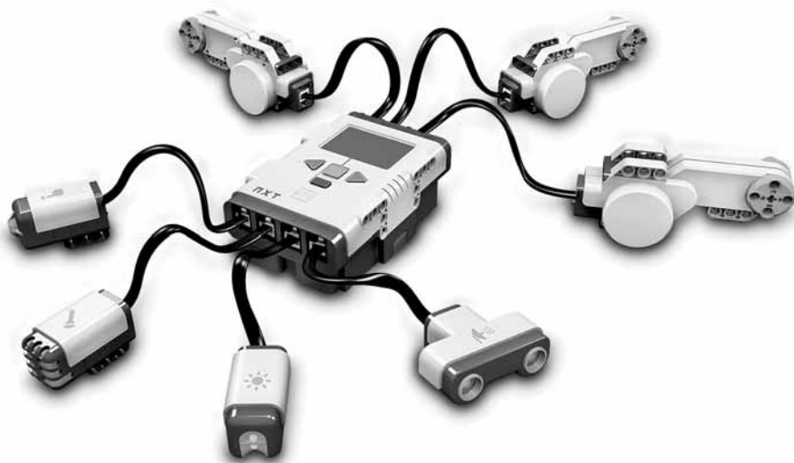
Figura 9. Lego Nxt con el conjunto de motores y sensores que vienen con el kit.
